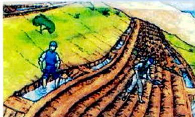
**Manejo zanjas abiertas de drenajes** Las pendientes de estas zanjas deben diseñarse de manera que se permita un mantenimiento de rutina en los cortes de la cobertura vegetal. En el fondo de las zanjas no debe permitirse que el agua se estanque.
